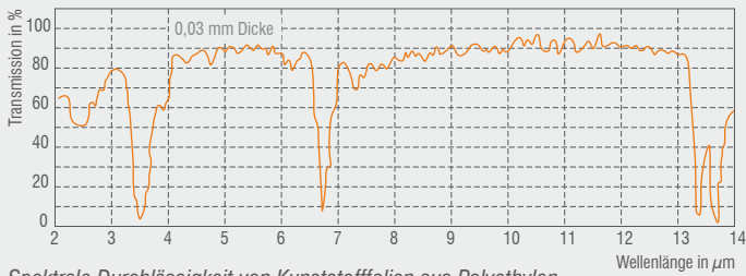
Spektrale Durchlässigkeit von Kunststofffolien aus Polyethylen
