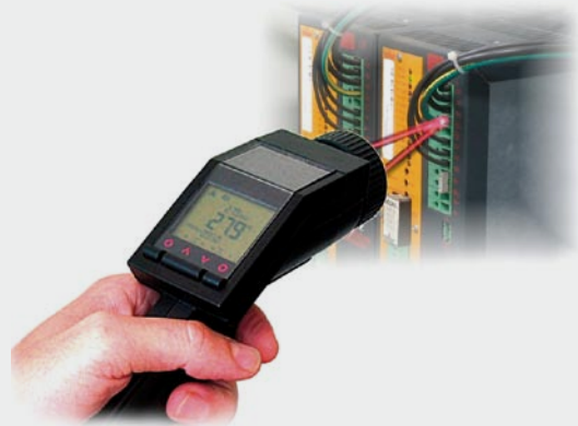
Detaillierte Infrarottemperaturmessung an einer elektrischen Steuerung mit Hilfe der eingebauten Scharfpunkt optik des LS im 1 Millimeterbereich
