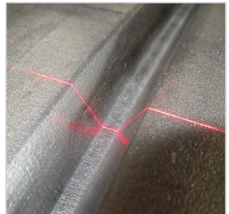
V-Nahtmessung an Rohren
