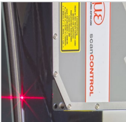
Spaltmessung an Fahrzeugkarossen
