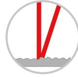
Rauhe und strukturierte Oberflächen verursachen Interferenzen im Laserpunkt, die zu einer fehlerhaften Abbildung auf dem Sensorelement führen. Dieser Effekt tritt besonders bei Metalloberflächen auf.
