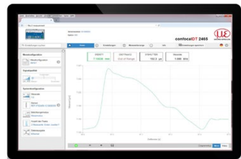
Einfache Parametrierung über integriertes Webinterface
