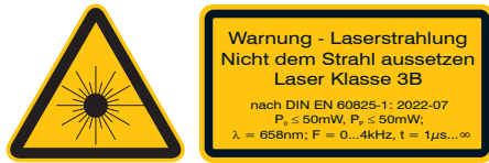
Abb. 3 Laserwarnschild und Laserhinweisschild, LLT 25xx-25, 25xx-50, 25xx-100
