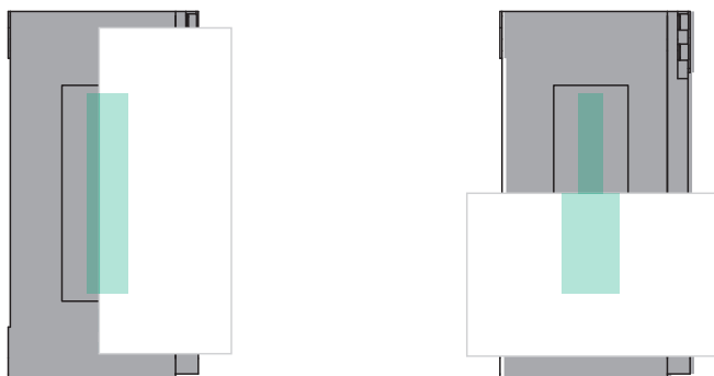
Abb. 4.8: Justagekontrolle mit Projektionsschirm (Papier) vor dem Empfänger, links vertikale und rechts horizontale Orientierung
