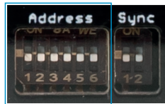
Abb. 63 Ausschnitt Dipschalter am induSENSOR MSC7602 für den Mehrkanalbetrieb
