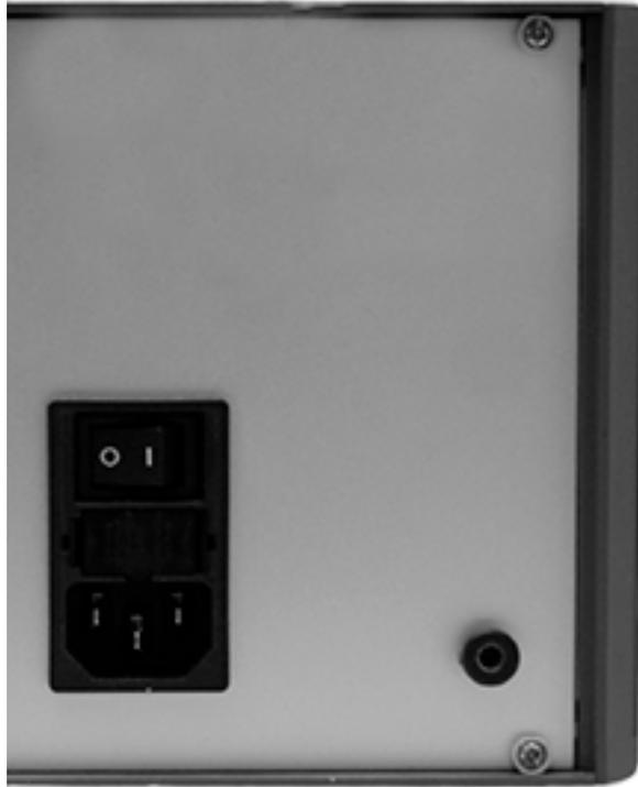
Abb. 17 Rückansicht mit Kaltgerätestecker, Sicherung; 230 VAC
