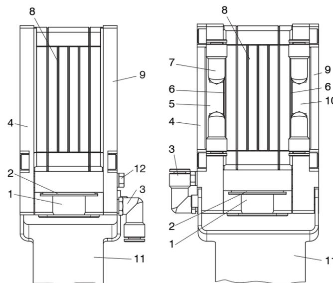
Zusammensetzung Schutzgehäuse und Schutz-/Kühlgehäuse
