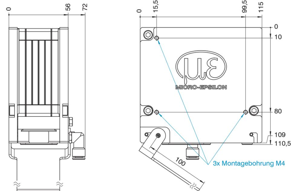
Schutzgehäuse mit Freiblaseeinrichtung, Artikel 2105076, Abmessungen in mm
