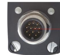
Versorgungsspannung/RS232/422 12-polige M12-A-Buchse, Typ Binder
