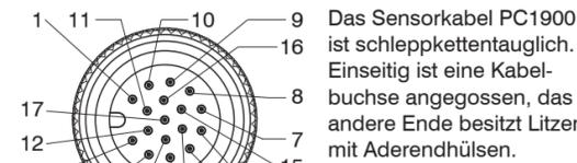
Das Sensorkabel PC1900 ist schleppkettentauglich. Einseitig ist eine Kabelbuchse angegossen, das andere Ende besitzt Litzen mit Aderendhülsen.
