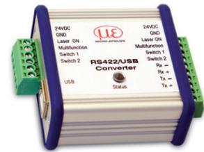
Symmetrische Differenzsignale nach EIA-422, nicht galvanisch von der Versorgungsspannung getrennt. Verwenden Sie ein geschirmtes Kabel mit verdrehten Adern, z. B. PC1900-x.
