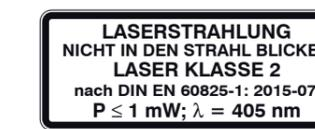
Abb. 1 Laserwarnschild, deutsch
