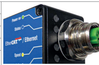
Abb. 6 LEDs an der Ethernet/ EtherCAT-Buchse
