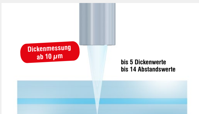
Mehrschicht-Dickenmessung z.B. von dünnen Beschichtungen und Spaltmaßen ab 10 \mu\text{m}
