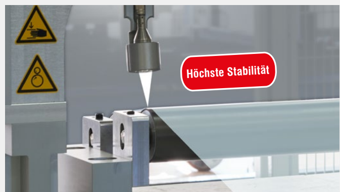
Inline-Dickenmessung von beschichteten Separatorfolien
