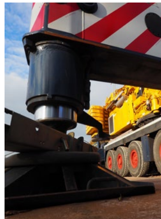
Variable Abstützung von Fahrzeugkränen
