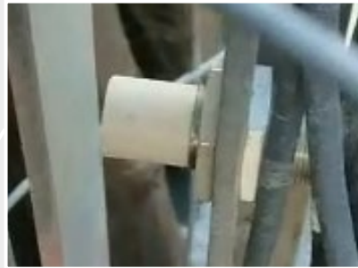
Rissüberwachung mit LVDT Wegsensoren; die Sensoren können auch an MSC-Mehrkanalcontroller angebunden werden
