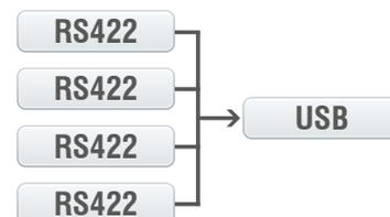
Anschluss von 4 Sensoren über IF2008-Y-Adapterkabel
