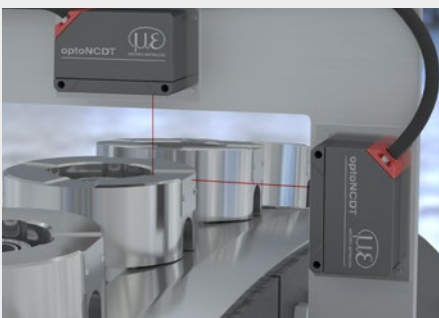
Dimensionsprüfung von Drehteilen
