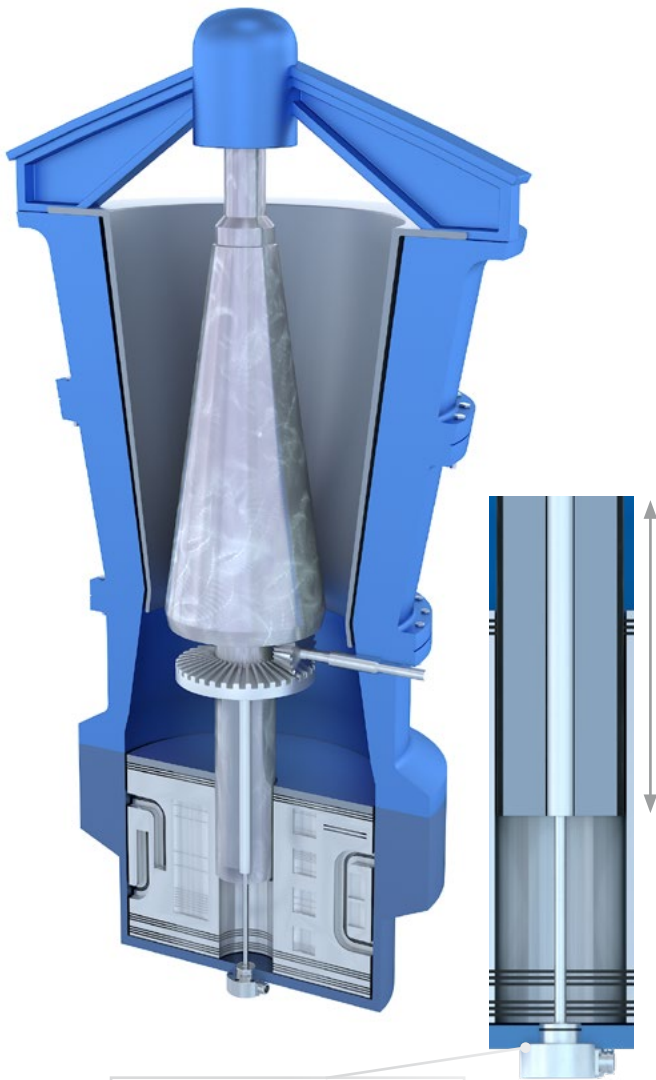
EDS-F: Messung des Mahlspalts in Gesteinsbrechern
