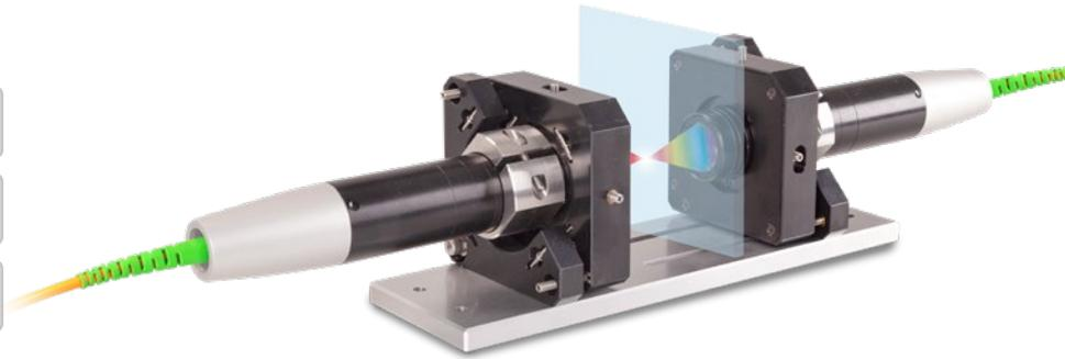
Der Montageadapter JMA-Thickness unterstützt bei der zweiseitigen Dickenmessung die Ausrichtung der Messpunkte zueinander. Auf diese Weise werden die Messpunkte absolut deckungsgleich angeordnet, sodass die Sensoren exakt auf einer optischen Achse liegen. Dadurch wird ein versetztes Messen verhindert und ein zuverlässiges Messergebnis mit größtmöglicher Präzision erreicht.
